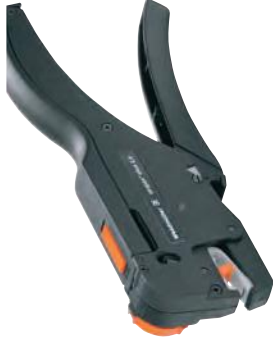
Stripax PLUS 2.5 Cortar, Decapar e Crimpar terminais isolados em tiras, de 0,5...2,5 mm 2 .
